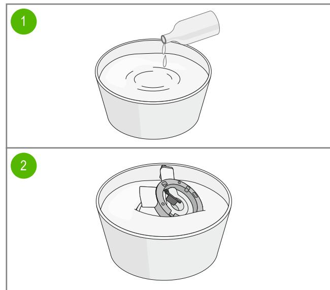
Детали соковыжималки можно тщательно вымыть следующим образом: на 30 мин. погрузите детали в теплую воду, в которую предварительно добавьте немного пищевой соды или средства для мытья посуды.
