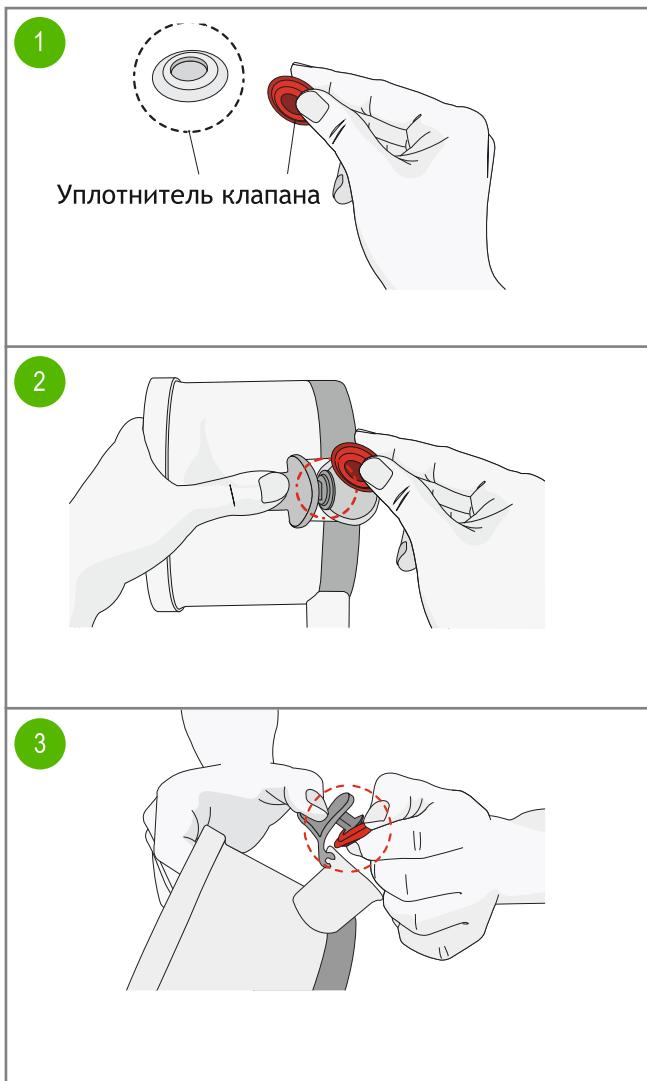
Возмите уплотнитель клапана как показано на рисунке. Вы должны видеть отверстие в уплотнителе.
