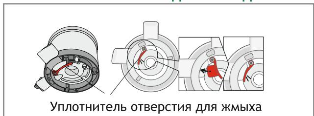
Силиконовый уплотнитель, который установленный на дне колбы, останавливает проникновение жмыха. Перед использованием убедитесь, что уплотнитель закрывает соответствующее отверстие. Вынимайте уплотнитель из отверстия для того, чтобы промыть колбу от остатков продуктов.
